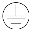
3872 – Kennzeichnung Erdung. Die Kennzeichnung Erdung auf der Skizze (Anschlussseite des Geräts bzw. die Seite des Geräts, an der sich der Klemmkasten befindet) zeigt den Erdungspunkt für den bauseitigen Erdungsanschluss. Die Erdungsverbindungen am Gerät selbst sind ebenfalls mit diesem Aufkleber gekennzeichnet (nicht auf der Skizze aufgeführt).
